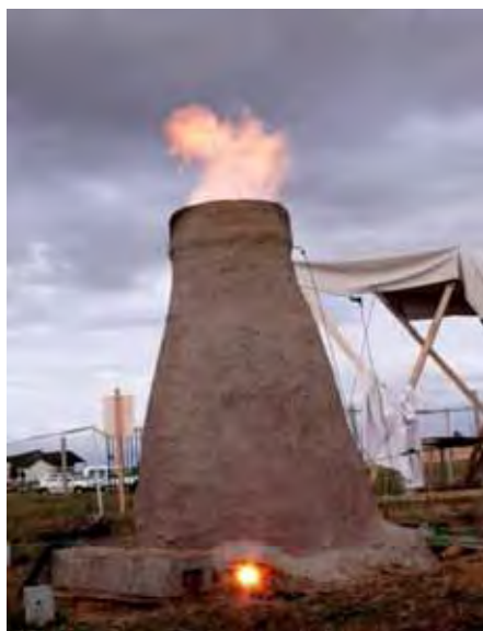
Photo 01 : Bas fourneau fonctionnant en ventilation naturelle, Gisacum, 08-2010.
