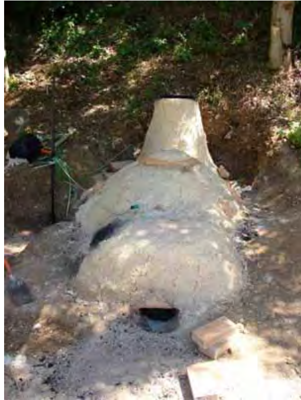
Expérimentation d'un four à réverbère du XVIIe S. (d'après les données de prospection recueillies sur le site Santa Isabel, Bolivie).
