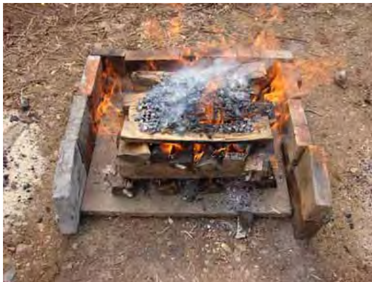
Grillage de la galène pour la fonte du minerai de plomb
